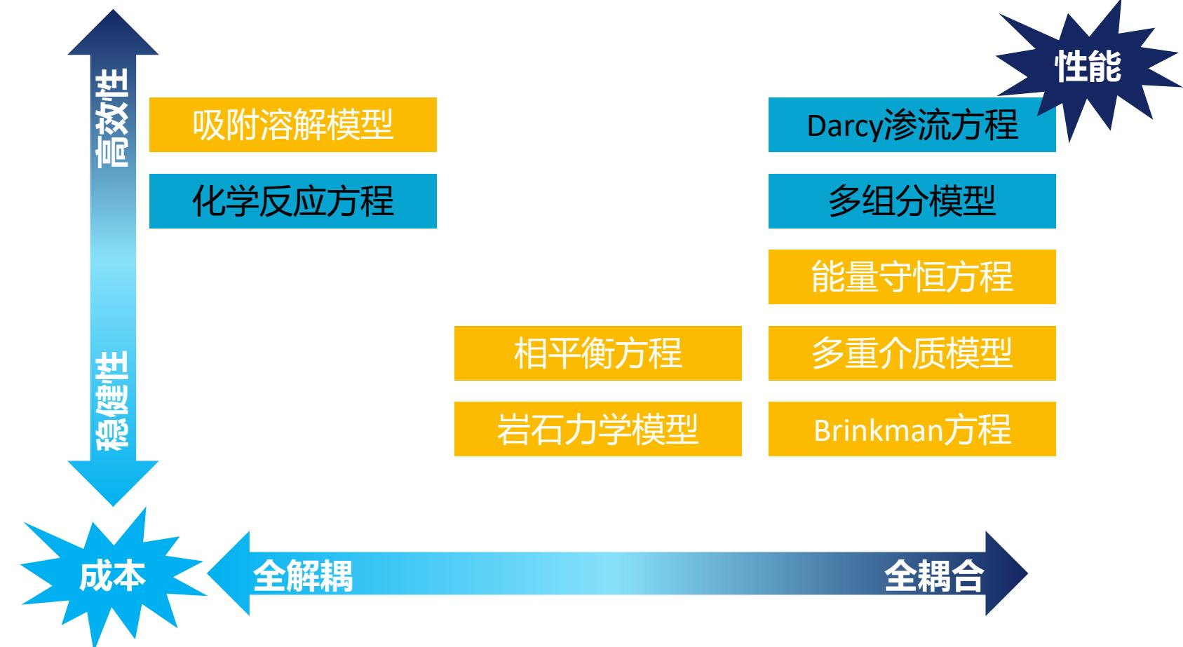
全隐式方法 + 向后Euler时间离散 + 自适应时间步长 + Newton线性化 + 无结构网格
